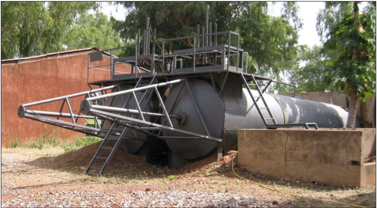
*Biodigesteurs de 25 m<sup>3</sup>*
